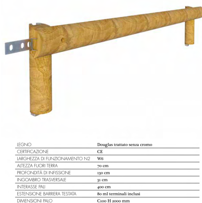
Figura 13 – Tipologia guard rail misto metallo-legno
